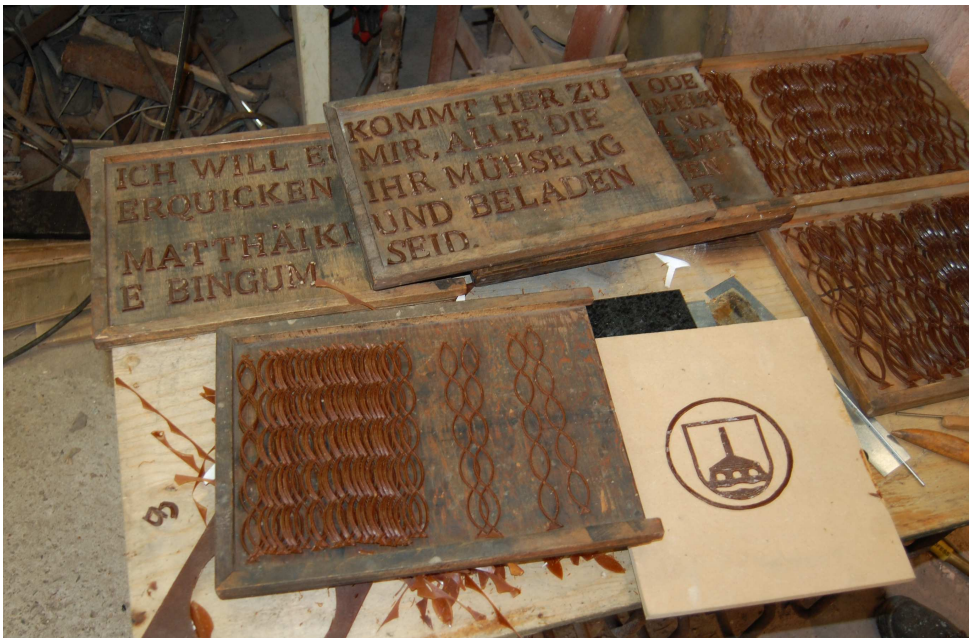
Glockenzier für die Christusglocke. Wachsbuchstaben für die Umschrift und Ornamentik der Glocke
