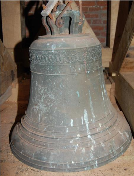
und A. van Bergen in Stickelkamperfehn gegossen worden war. Das Gewicht dieser Glocke mit dem Schlagton c'' und leichter Rippe liegt bei ca. 200 kg (?). Sie hat eine umlaufende Weinblatt-Ornamentik und trägt als einzigen Schriftzug den Namen BINGUM.
